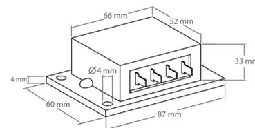
Wird zwischen Solarpanel 12 V/DC und 1 oder 2 Akkus geschaltet, um ein Überladen der Akkus zu verhindern. Sind 2 Akkus angeschlossen, werden diese getrennt voneinander geladen. Es bekommt immer der Akku mehr Ladestrom, der die niedrigste Ladespannung hat. Mit LED-Anzeigen + hoher Ladeleistung: max. 2 x 8 A oder 1 x 16 A.
