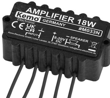
Robustes Verstärkermodul für den universellen Einsatz. Das Modul ist feuchtigkeits- und rüttelfest vergossen. Die Vergussmasse und das Modulgehäuse bestehen aus einem speziellen, hoch wärmeleitfähigen Kunststoff. Daher sind keine zusätzlichen Kühlkörper erforderlich. Das Modul ist elektronisch gegen Überhitzung und Überlastung gesichert.
