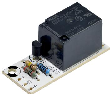
Diese Relaiskarte kann mit schwachen Signalen ab ca. 5 mA angesteuert werden und schaltet dann ein Relais mit einem Starkstromkontakt von 3 A. Ideal als Schaltverstärker für andere Bausätze, die als Ausgang nur eine Leuchtdiode haben und über den Relaiskontakt andere Geräte und Maschinen schalten sollen.
