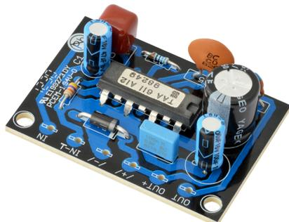
Kleiner Universal-Verstärker mit einer Musikleistung von 2 W Spitze. Ein moderner, preisgünstiger Verstärker für viele Zwecke. Er arbeitet mit einem 8-poligen DIP-IC, die Bauform ist sehr klein, sodass dieser Verstärker sich in viele Geräte integrieren lässt.
