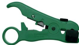
Es verfügt über einen umsteckbaren Abisolierblock mit fest eingestellten Absetzmaßen. Das Absetzmaß 8/13 mm ist für alle AXING Antennendosen der premium-line vorgesehen, das Absetzmaß 7/6 mm für die AXING Kompressionsstecker.
